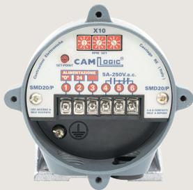
Le contrôleur de rotation numérique SMD20 assure la surveillance de la vitesse de rotation de n'importe quel arbre rotatif. Le capteur ferme un contact lorsque la vitesse réglée n'est pas respectée. Version avec raccord direct. Le contrôleur de rotation numérique CAMLogic peut être monté dans n'importe quelle position.
