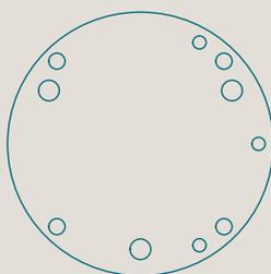
Membrane en **caoutchouc para** jusqu'à **+60 °C**
