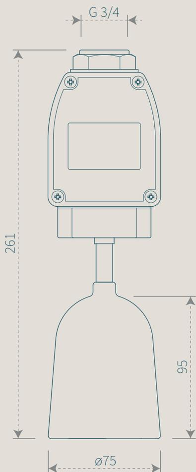
Montaggio tramite sospensione a tubo
